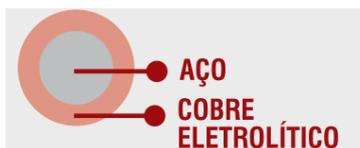
Retilíneas, constituídas de núcleo sólido de aço carbono, revestida por camada uniforme de cobre eletrolítico (mínimo 254 microns) através do processo de eletrodeposição anódica, que garante união inseparável e homogênea dos metais.
