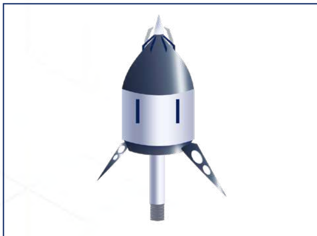
Figura 2 – Representação de Captor Early Streamer Emission (ESE).
